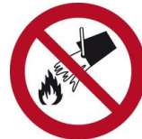
Mit Wasser löschen verboten
