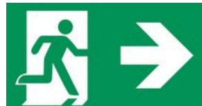
Beispiel für Rettungsweg Notausgang mit Zusatzzeichen (Richtungspfeil) |
