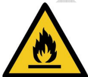
Warnung vor feuergefährlichen Stoffen
